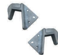
Ils fournissent une plus grande fixation aux escaliers. Accessoire universel applicable à toute échelle. Les crochets sont en aluminium injecté et servent à fixer l'échelle à un tuyau ou à un rail et à l'empêcher de bouger. Soutenez toujours les pieds de l'échelle au sol et ne travaillez pas avec l'échelle en suspension. Mesures de diamètre 50 mm. Kit sans attaches (rivets ou vis).
