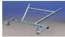
Idéal pour les tâches nécessitant une échelle séparée au mur. Il permet à l'opérateur de travailler à une certaine distance du mur tout en offrant un soutien stable et sûr à l'échelle. Facile à utiliser, il convient à toute échelle de profil maximum 84 mm. Convient pour les travaux de peinture et de nettoyage. Séparation minimale: 38 cm
