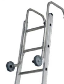
Pièce d'application dans les escaliers, pour le support lors de l'utilisation. Empêche le glissement des échelles sur le toit - le point de fixation du support est fourni comme sur la photo 1. Sur demande, il peut être construit comme la photo 2. Convient aux échelles d'une largeur intérieure minimale de 38 mm.
