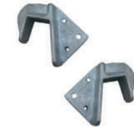
Ils fournissent une plus grande fixation aux échelles. Accessoire universel applicable à toute échelle. Les crochets sont en aluminium injecté et servent à fixer l'échelle à un tuyau ou à un rail et à l'empêcher de bouger. Soutenez toujours les pieds de l'échelle au sol et ne travaillez pas avec l'échelle en suspension. Mesures de diamètre 50 mm. Kit sans attaches (rivets ou vis).
