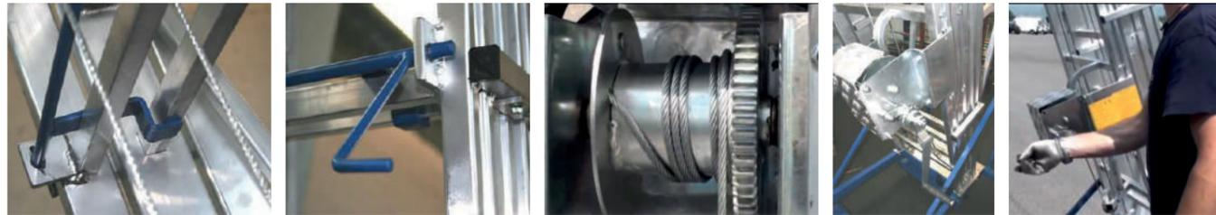
Le moulinet à manivelle permet un levage télescopique de l'échelle à la hauteur souhaitée (tous les 28 cm). Le mouvement est rapide et fluide et doit être effectué en l'absence de charges ou de personnes sur l'échelle. Le dispositif en acier verrouille manuellement l'échelle à chaque hauteur souhaitée et l'empêche de tomber en cas de coupure accidentelle du câble de levage.
