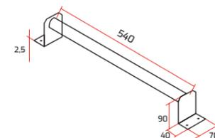
Construite en aluminium, la barre de support permet à l'utilisateur de supporter l'échelle avec un kit de crochets, afin de fournir une plus grande sécurité dans le travail à effectuer, en empêchant l'échelle de se déplacer. Vis de fixation et cadenas non inclus.
