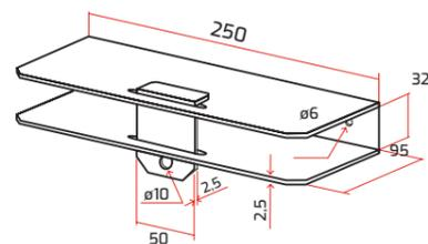
Fabriquée en acier zingué, l'échelle peut être rangée verticalement et de manière permanente. Le loquet se présente sous la forme d'un tiroir avec une patte de fermeture dans laquelle un cadenas est inséré. Vis de fixation et cadenas non inclus.
