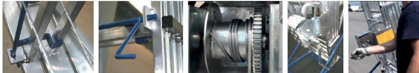
O carro com a manivela permite a elevação telescópica da escada até à altura desejada (cada 28 cm). O movimento é rápido e fluido e deve ser efetuado em ausência de cargas ou pessoas em cima da escada. O dispositivo em aço bloqueia manualmente a escada a cada altura desejada, impedindo a queda em caso de corte accidental da corda de elevação.
