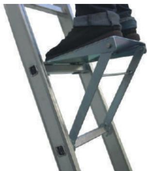
Antideslizante fabricada em alumínio. Plataforma universal para colocar sobre qualquer escada, cujo degrau seja de secção entre 25 e 30 mm e com uma distância entre degraus de 250 a 300 mm.
