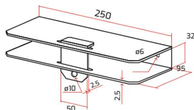
Fecho construído em aço zincado, permite guardar a escada de forma vertical e permanente. O fecho é construído em forma de gaveta com patilha de fecho onde é introduzido um aloquete. Parafusos de fixação e aloquete não incluídos.
