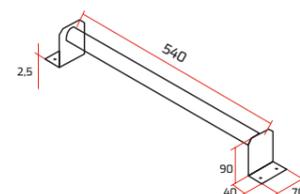
Construída em alumínio, a barra de apoio permite ao utilizador apoiar a escada com kit ganchos, de modo a proporcionar maior segurança no trabalho a realizar, evitando que a escada se mova. Parafusos de fixação e aloquete não incluído.
