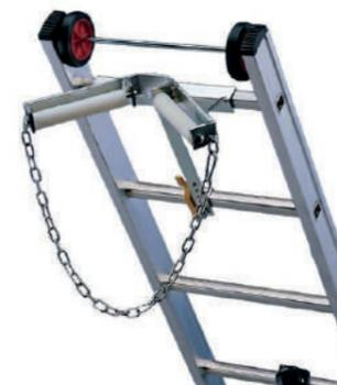
Acessório universal construído para permitir um melhor apoio e deslizamento sobre postes, árvores ou colunas. Rodas de apoio em nylon e corrente de segurança. Inclui parafusos de fixação. Distância obrigatória 28 cm. Acessório utilizável em escadas extensíveis.
