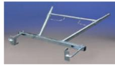
Ideal para tarefas que requerem separar a escada da parede. Permite ao operário trabalhar a uma certa distância da parede e ao mesmo tempo proporciona um apoio estável e seguro na escada. Fácil de usar, serve para qualquer escada de perfil máximo 84 mm. Indicado para realizar tarefas de pintura e limpeza. Separação mínima: 38 cm. Separação máxima: 72 cm.
